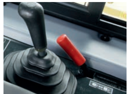
Schild-Steuerhebel mit automatischer Schnittwinkelverstellung und neuer Heckaufreißer-Steuerhebel mit Funktion zum automatischen Anheben des Heckaufreißers
