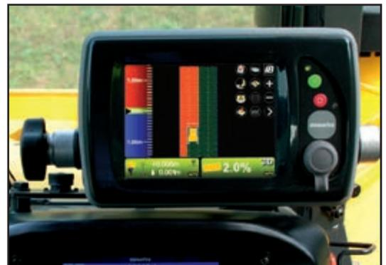
Die serienmäßige Steuereinheit mit Touchscreen wird ebenfalls ab Werk installiert und stellt dem Fahrer eine leicht verständliche und intuitiv zu bedienende Benutzeroberfläche zur Verfügung.
