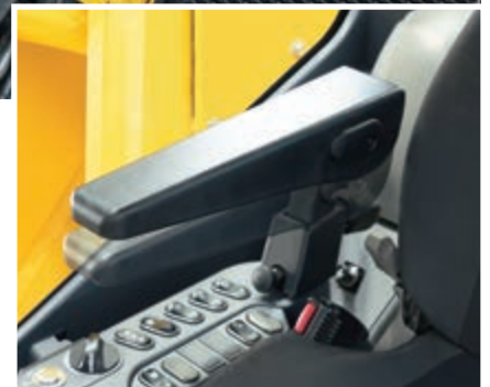
Armstütze mit einfacher Höhenverstellung
