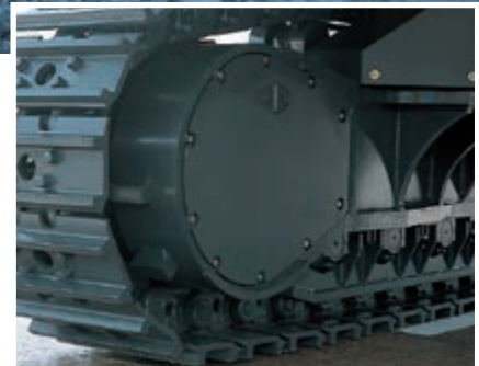
Robuster Schutz der Fahrmotoren und Felsschutz
