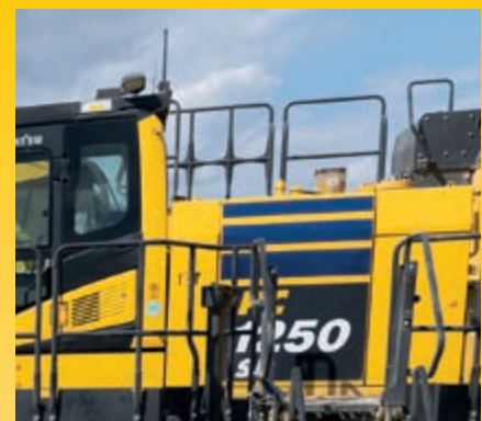
Handläufe und rutschfeste Oberflächen
