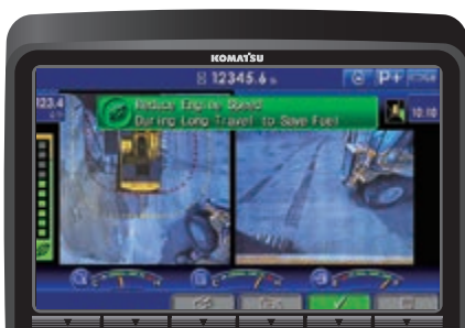
Eco-Anzeige, Eco-Hinweise und Kraftstoffanzeige
