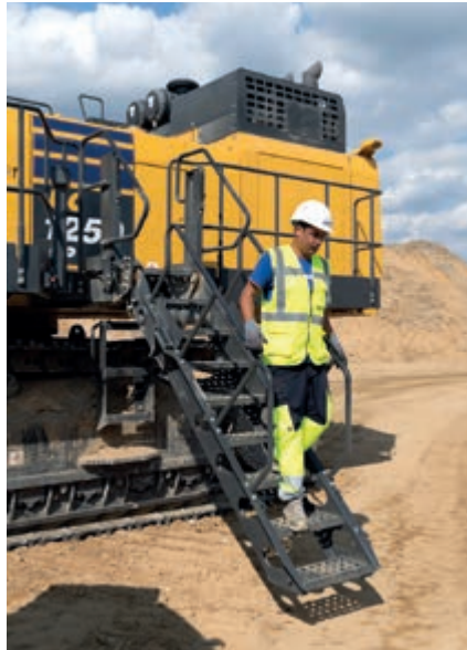
Die zur Standardausrüstung gehörende, hydraulisch betätigte Zugangsleiter stellt sicheren Zugang zur Kabine sicher.
