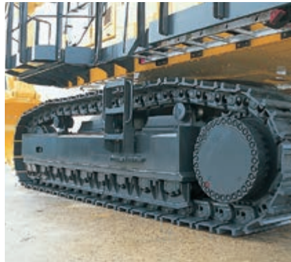
Laufrollenschutz über die gesamte Laufwerkklänge (Option)
