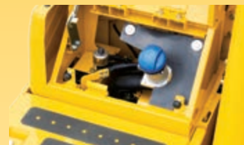
Der AdBlue®-Tank ist an der vorderen Leiter installiert und somit leicht zu erreichen.
