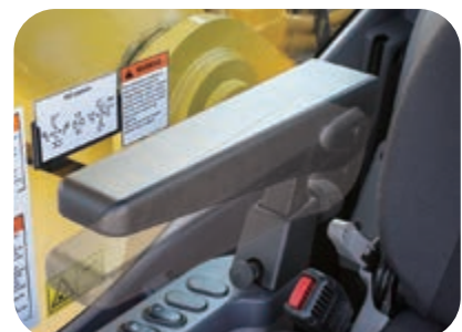
Armstütze mit einfacher Höhenverstellung
