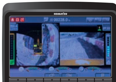
KomVision zeigt zusätzlich zu den verschiedenen Kameraansichten eine permanent verfügbare Draufsicht („Birdview“) an
