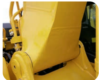
Gegossener Auslegerfuß und einteilige Platten am Ausleger
