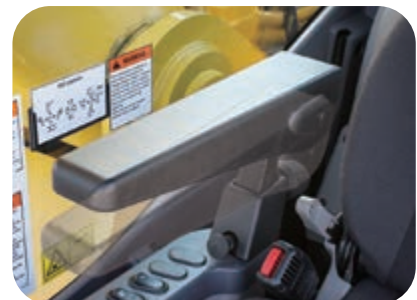
Armstütze mit einfacher Höhenverstellung
