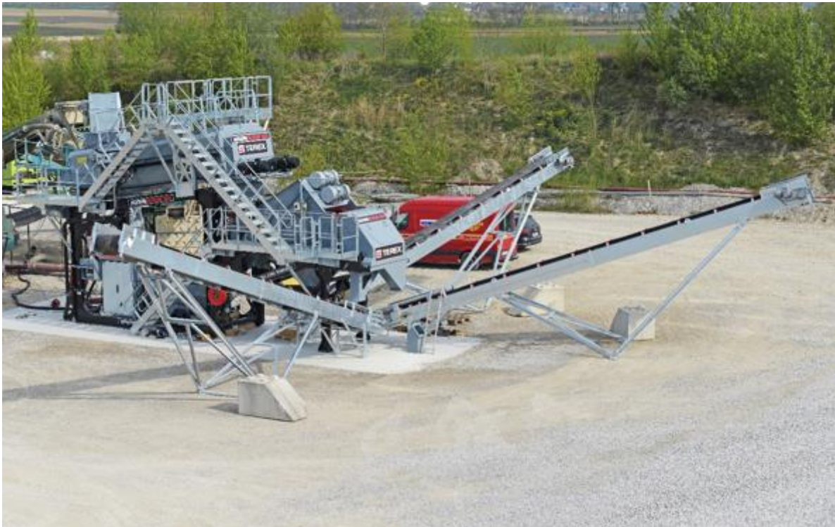
Die Anlage wäscht Sand und Lehm bestens ab und sortiert Kies in den Größen 4 bis 8, 8 bis 16 und 16 bis 32 Millimeter.
