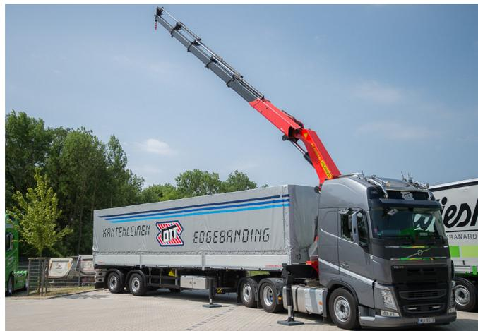
Der PALFINGER PK 40002 EH mit einer maximalen hydraulischen Reichweite von 21 Metern zeichnet sich durch hohen Komfort und Bedienerfreundlichkeit aus.
