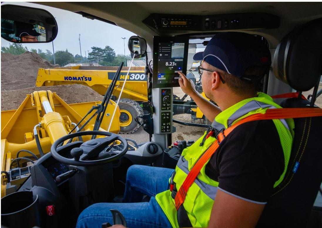
Foto (Komatsu): Der WA475-10 im Materialumschlag: Einfache und intuitive Bedienung der Assistenzsysteme mit Hilfe des neuen SubMonitor's.
