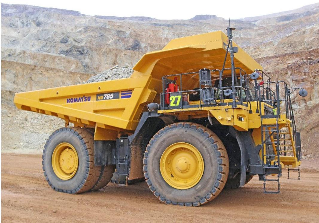
Der neue HD785-8 bietet mit seiner ergonomischen Fahrerkabine nicht nur mehr Qualität für den Fahrer, sondern verfügt auch über zahlreiche Sicherheitssysteme und einen effizienten Motor gemäß EU Stufe V. Die älteren HD785-7 bewähren sich bis 60.000 Betriebsstunden bei einer Verfügbarkeit von 90%.
