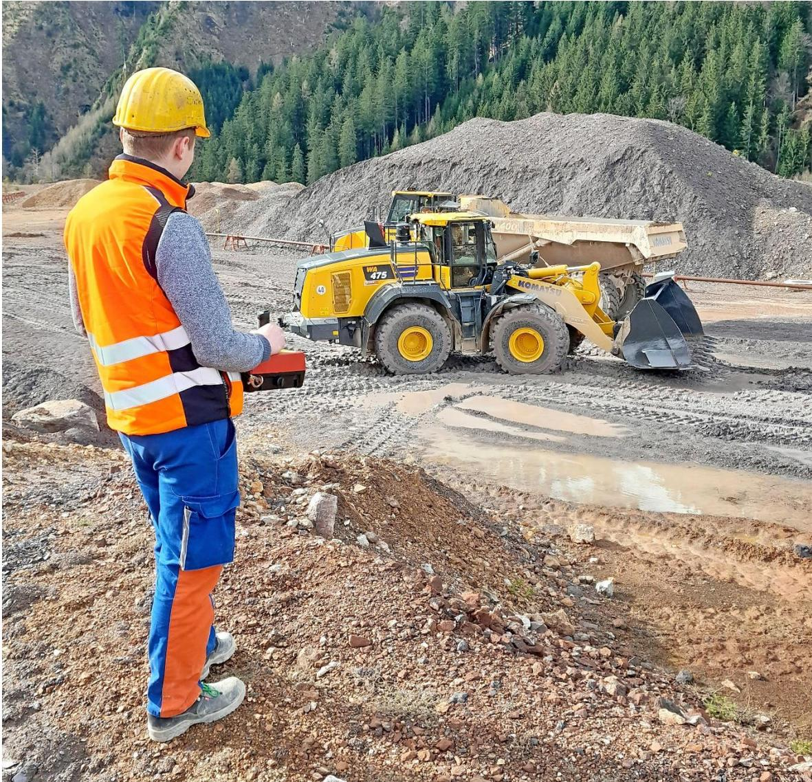
Der neue Komatsu Radlader WA475 kommt mit Funkfernsteuerung auch für Arbeiten in den Gefährdungsbereichen des Tagebaus zum Einsatz, ohne dass sich ein Mitarbeiter diesen Bereichen nähern muss.
