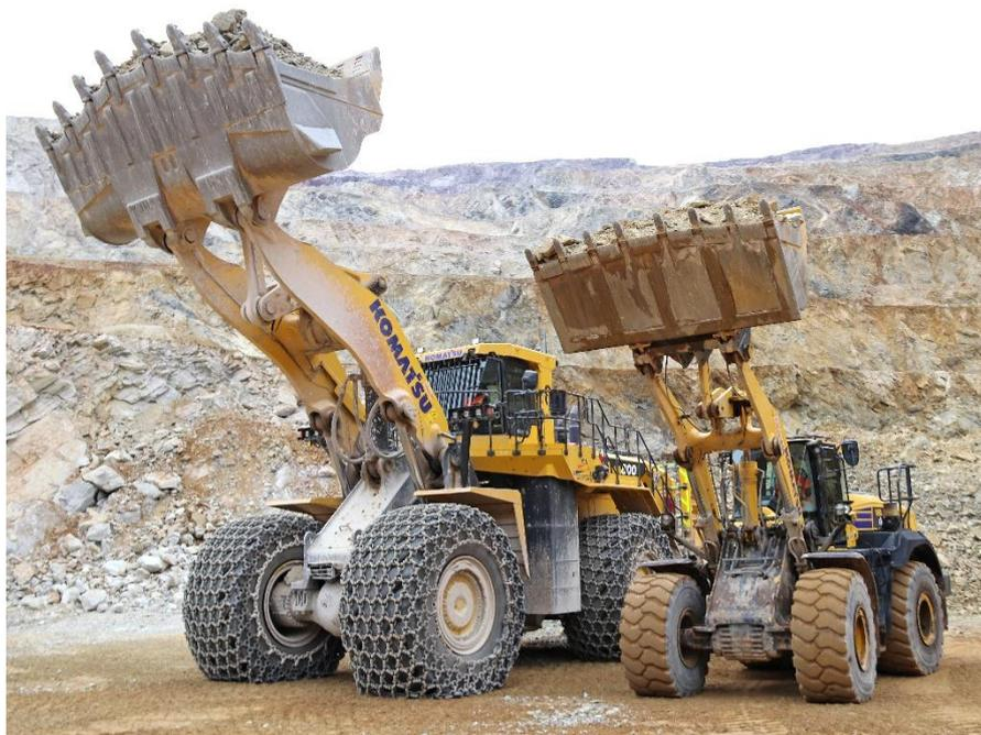
Im direkten Vergleich wird der Größenunterschied zwischen den Radladern WA800-8 und WA475 deutlich sichtbar.
