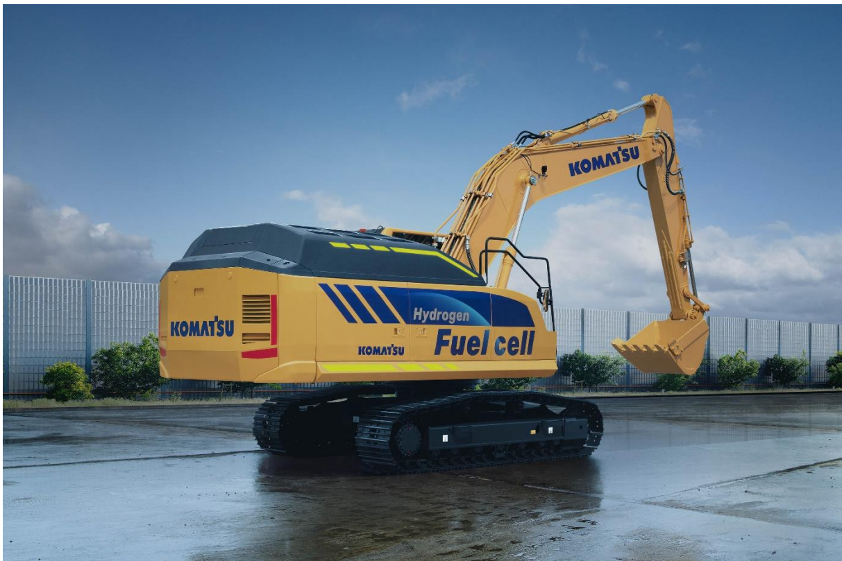
Konzeptmaschine für einen mittelgrossen Hydraulikbagger mit Wasserstoff-Brennstoffzelle
