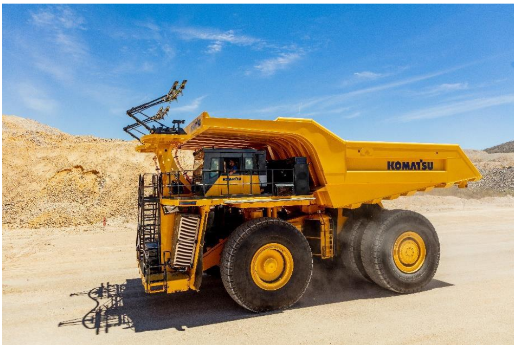
Der Energiequellen-unabhängige Muldenkipper von Komatsu beim Test in einem Komatsu-Werk in den USA.
