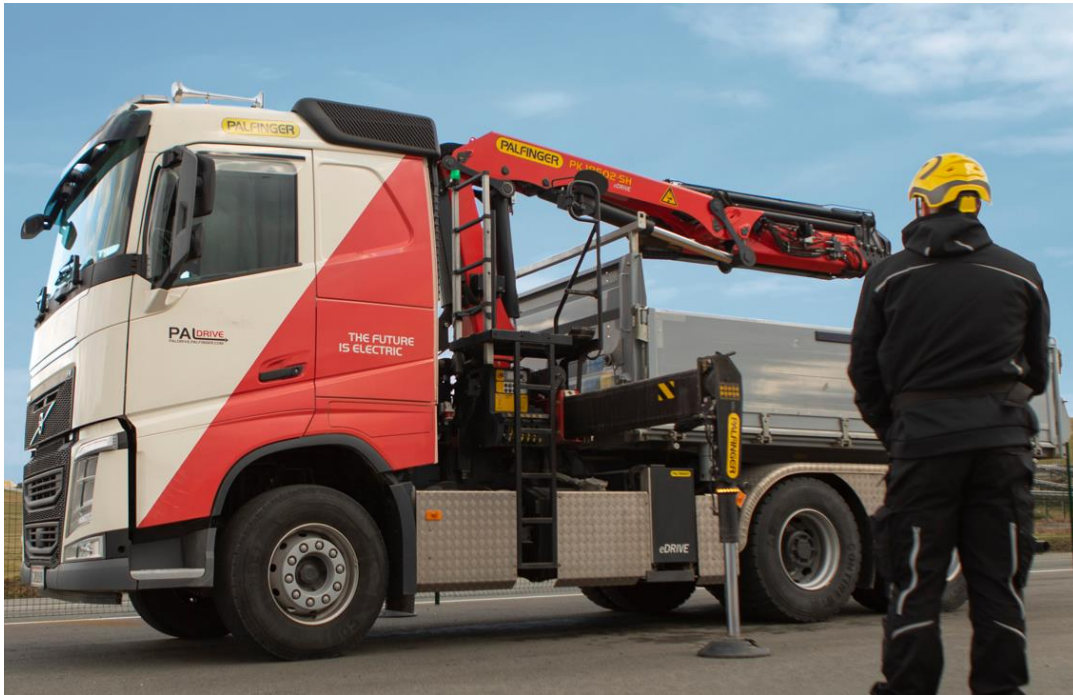
Ein Kran der PALFINGER SH-Reihe mit dem neuen eDRIVE System
