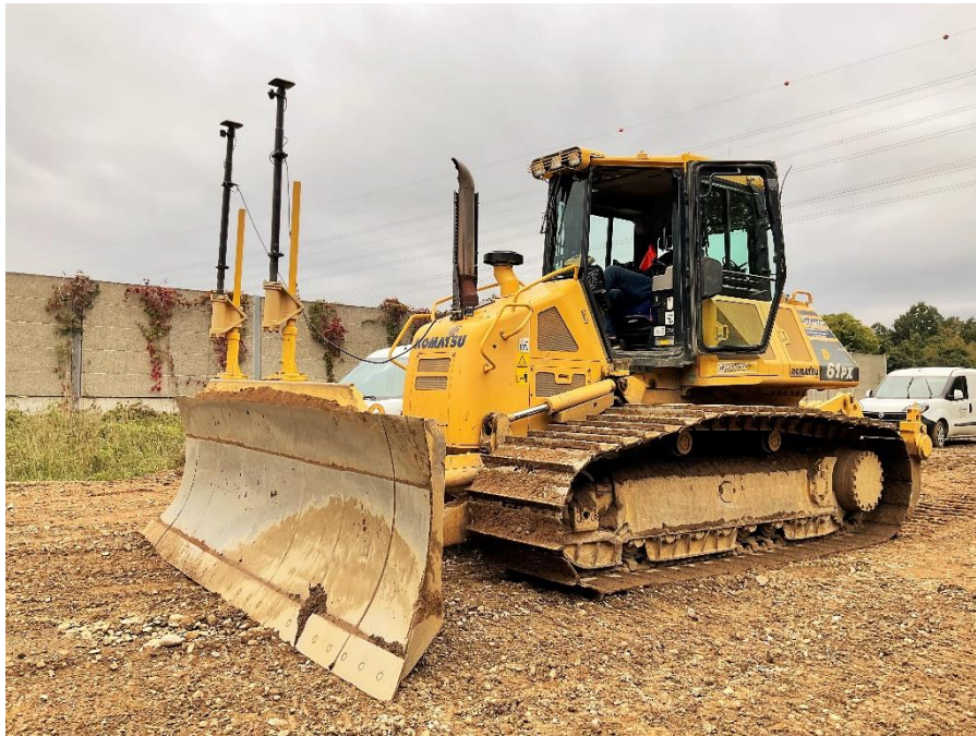
Die Firma Schuster verwendet auch für die Komatsu-Planierdraupe D61PX-15 eine Topcon-Maschinensteuerung. Vorne zu sehen die GPS-Masten.
