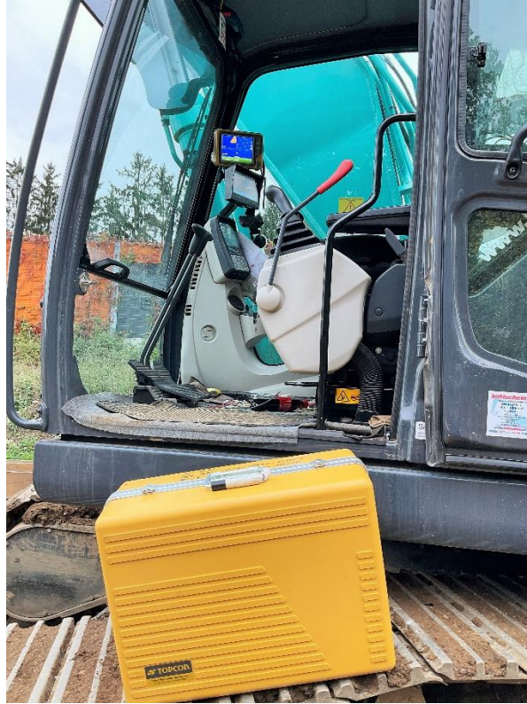
In Gelb der Aufbewahrungskoffer für den Topcon-Monitor und die GPS-Empfänger.
