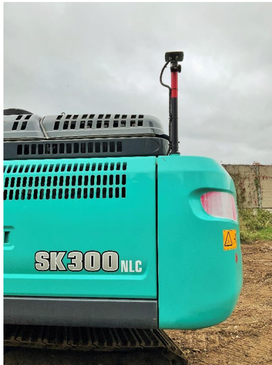
Der GPS-Mast der Topcon-Maschinensteuerung befindet sich am Heck des Baggers.
