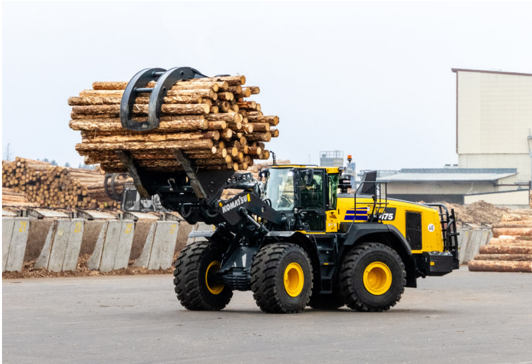
WA475-10 in der Holzindustrie Spezifikation mit neuem „Tool linkage“-Ausleger, hier genutzt für die Rundholzverladung.
