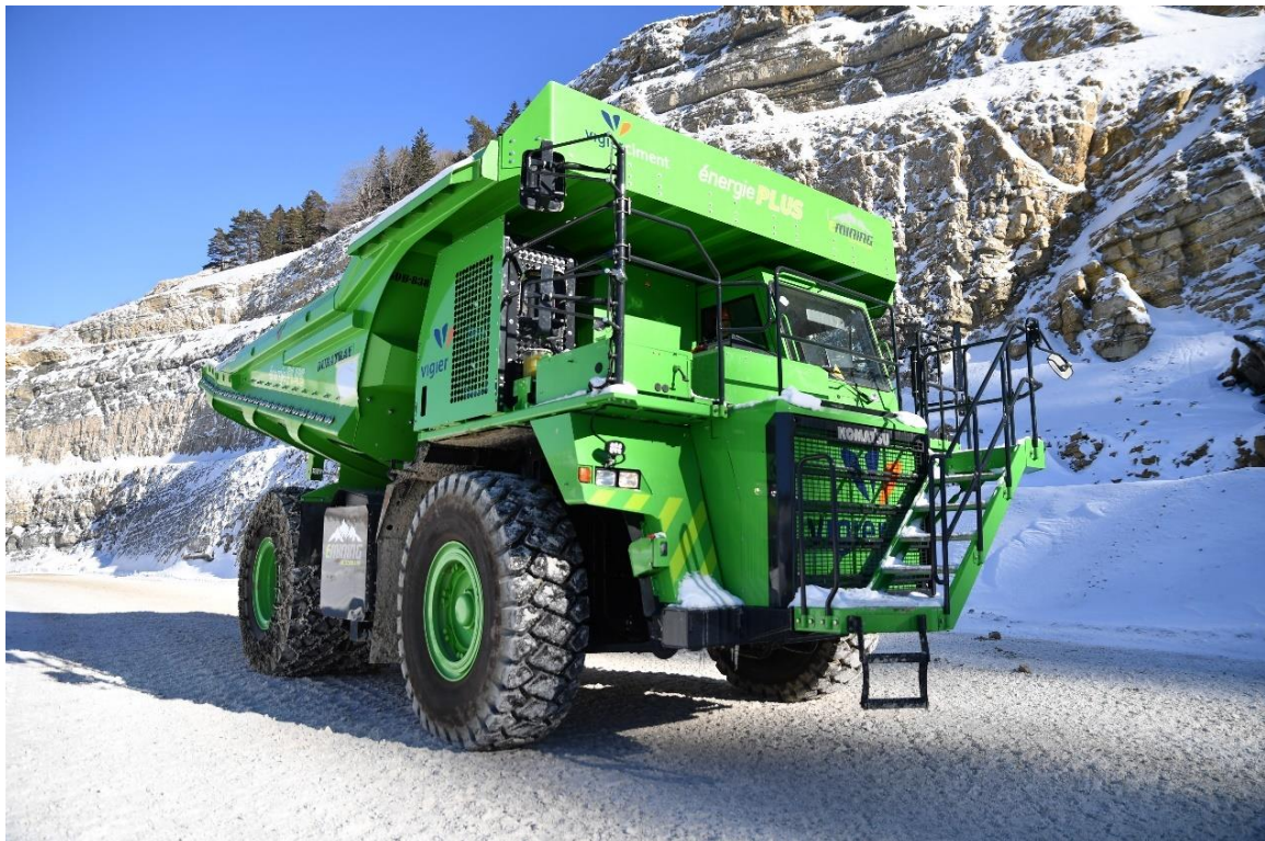
Der E-Dumper ist der größte batteriebetriebene Muldenkipper der Welt.
