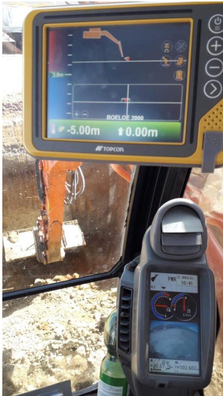
Die Firma Katzlberger hat die innovative 2D-Baggersteuerung X-52x von Topcon beim Baumaschinenhändler Kuhn erworben.
